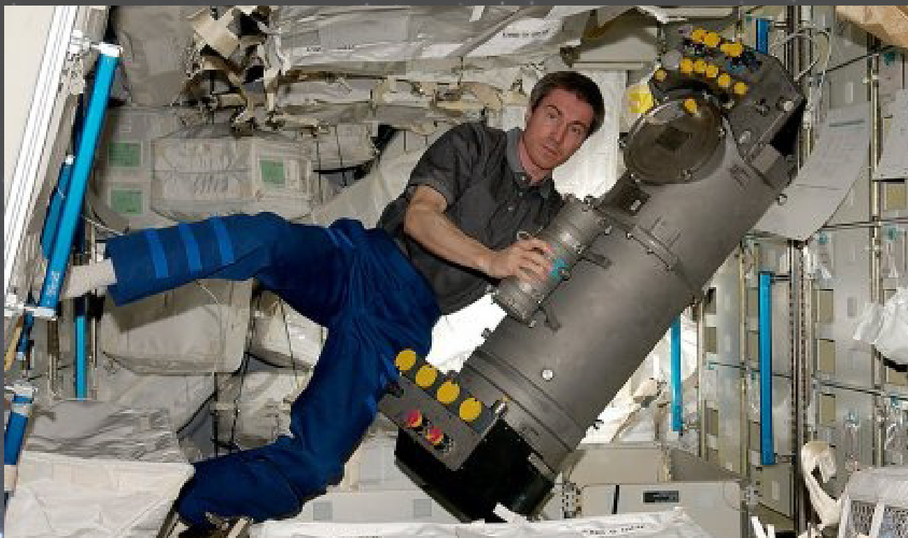
Космонавт Сергей Крикалев и главная часть системы «Электрон» - блок жидкостной. Именно в нем и происходит электролиз.
