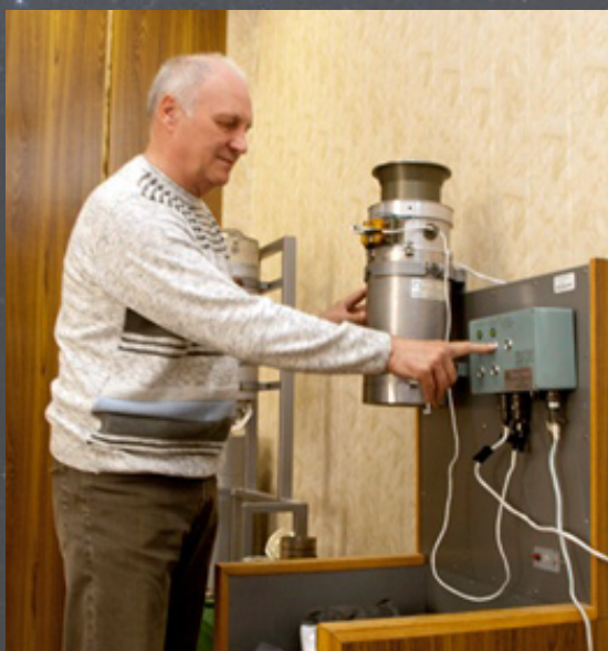
Инструктор космонавтов по системам кислородообеспечения демонстрирует работу твердотопливного генератора кислорода
